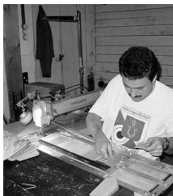
Damit die Montage später einfacher und schneller geht, werden die Rundschildeln zu grösseren Elementen zusammengenäht.
