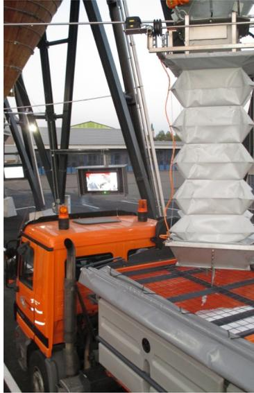
Runde Grosssilos mit Topautomatik und vollautomatisiertem Verladevorgang und Verbindung zur Verwiegung
