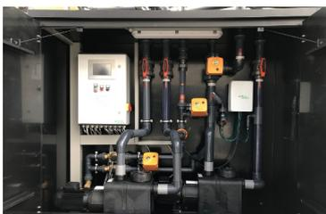
Générateur de saumure avec système de réservoir
